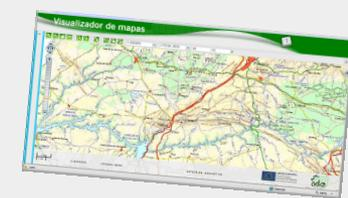
Ofrece la posibilidad de transformar las coordenadas de un punto o un conjunto de datos (en formato GML) de un Sistema de Referencia (CRS) a otro.
