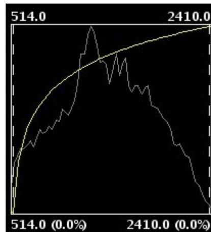
Realce radiométrico de tipo exponencial
